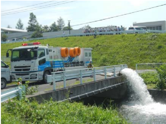
排水ポンプ車の稼働実演
