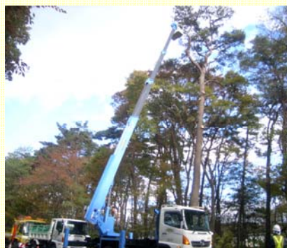
27mの高所作業クレーンを使い枝から伐採を始め、周りの樹木を傷つけないよう小さく切って下ろします。
