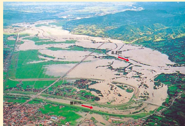
一関市の北上川と磐井川合流地点の一関遊水地 堤防ができる前の洪水時の様子
