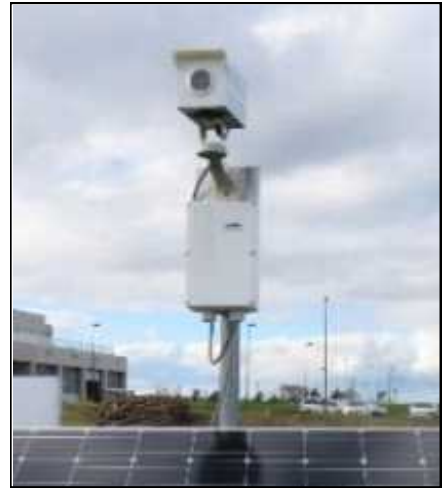
簡易型河川監視カメラ
