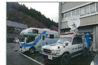
衛星通信車による途絶した通信回線の確保
