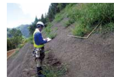
法面緑化後のモニタリング調査
