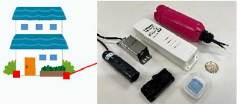
実証実験に用いている6種類の浸水センサ
