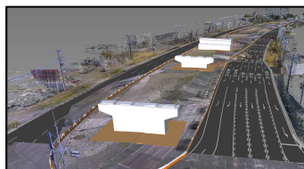
BIM/CIMによる4Dシミュレーション
