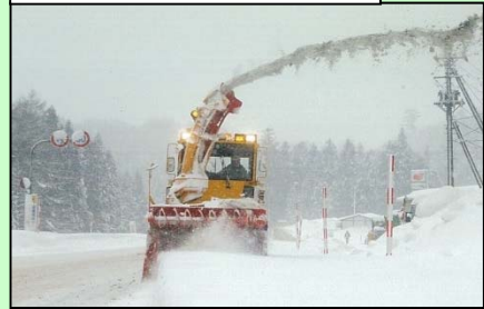
ロータリ除雪による作業状況
