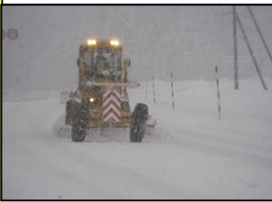
除雪グレーダによる作業状況
