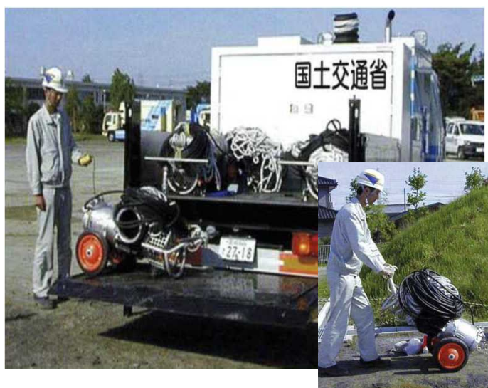
排水ポンプを積卸し、人力で移動
