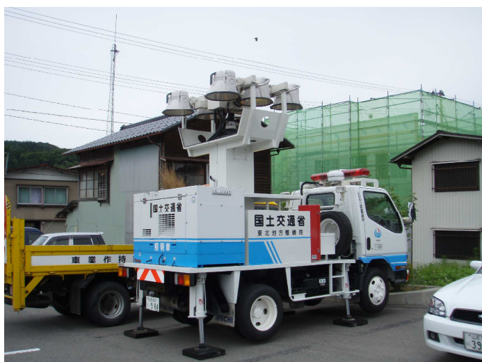
アウトリガーを設置し、車両を固定
