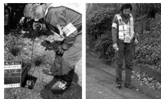
厚生労働大臣賞 時間積分式漏水発見器による 効率的な漏水発見手法(スクリーニング工法) 東京水道サービス(株)
