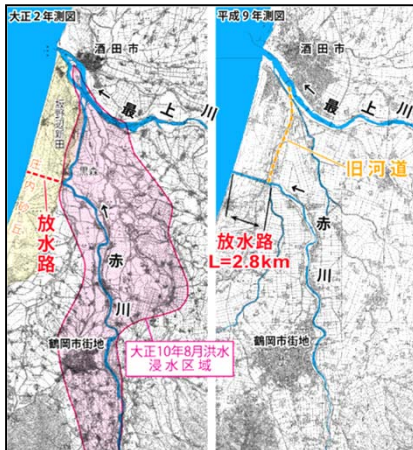
▲放水路の開削による流路の変遷
