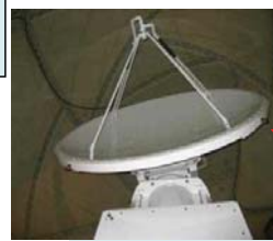
XバンドMPLレーダ雨量計 (アンテナ直径:約2m)
