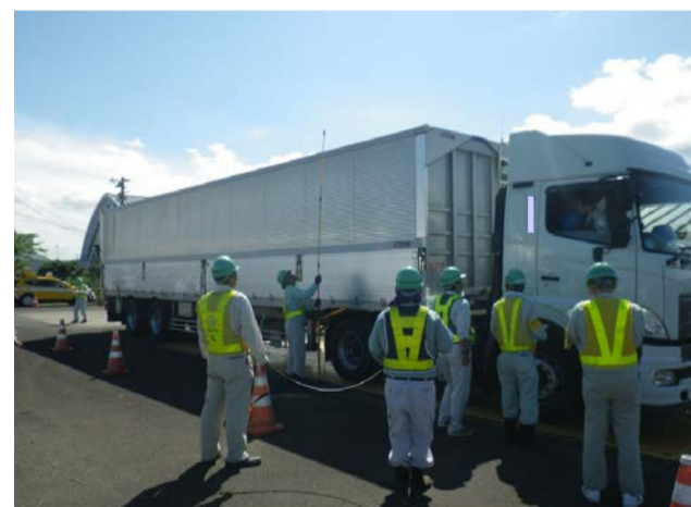
車両寸法の測定状況
