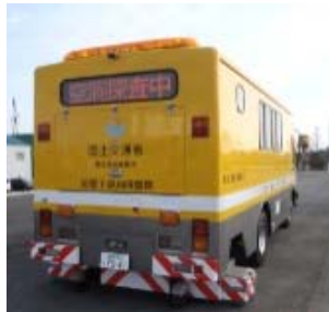
【路面下空洞調査】
