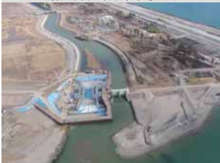
阿武隈川の堤防復旧状況 (新浜水門 岩沼市寺島地区)
