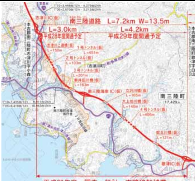
平成28年度 調査・設計、支障移転補償、橋梁工事、改良工事、舗装工事推進
