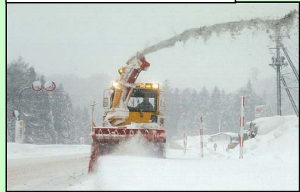
ロータリー除雪による作業状況
