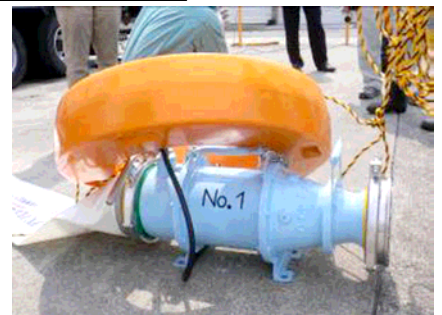
排水ポンプにホースとフロートを接続した状態
