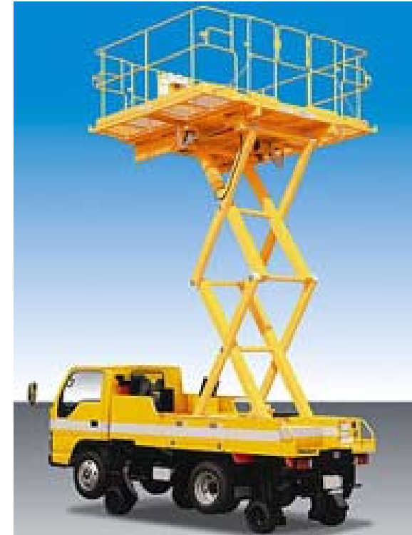
高所作業車 (高所で作業を行うためにその機構を 有した特殊車両並びに建設機械)
