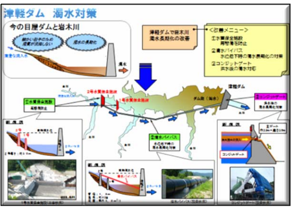
【濁水対策 水質保全施設等の整備】
