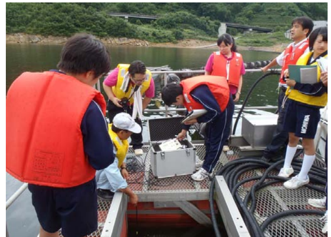
▲濁度計による水質調査の状況
