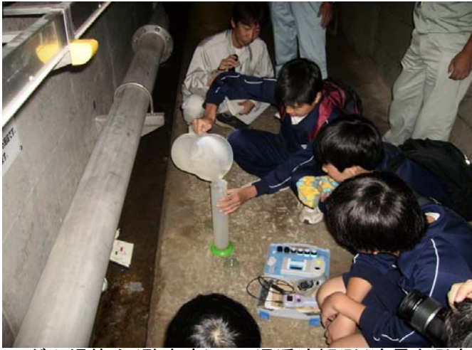
▲ダム堤体内(監査廊)での浸透流観測(流量を測定)
