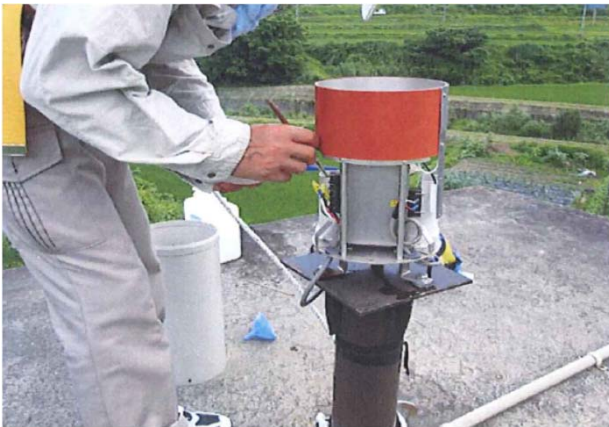
雨量計点検状況
