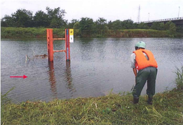
量水標点検状況
