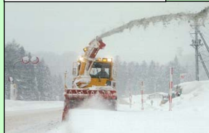
ロータリー除雪による作業状況
