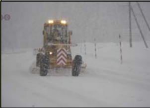
除雪グレーダによる作業状況
