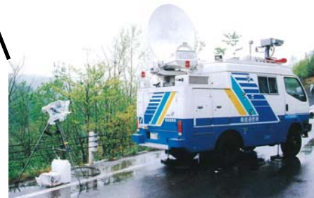
衛星通信車(建設福島)
