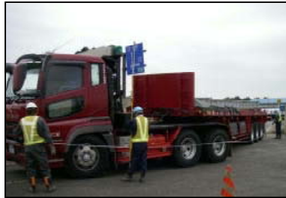
・車両の寸法を測定し、違反がないか確認
