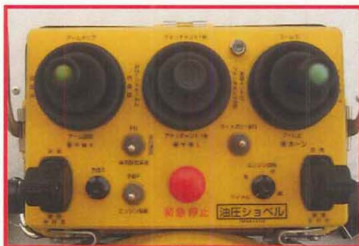
写真-3 ラジコン装置
