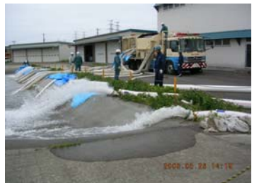
ポンプ車 60m 3 /min 水力タービン式
