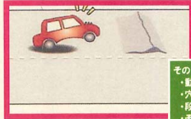
路面の隆起・陥没
