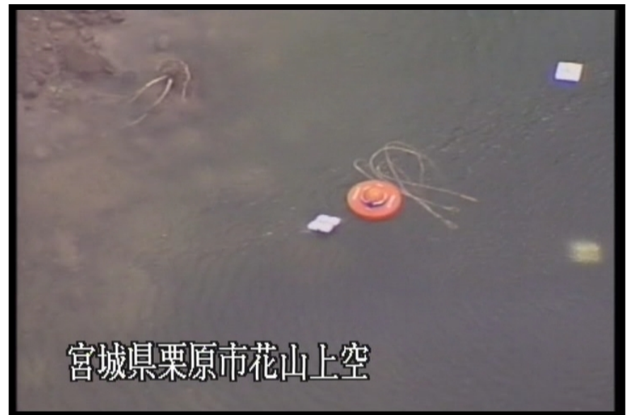
土研式水位計着水状況
