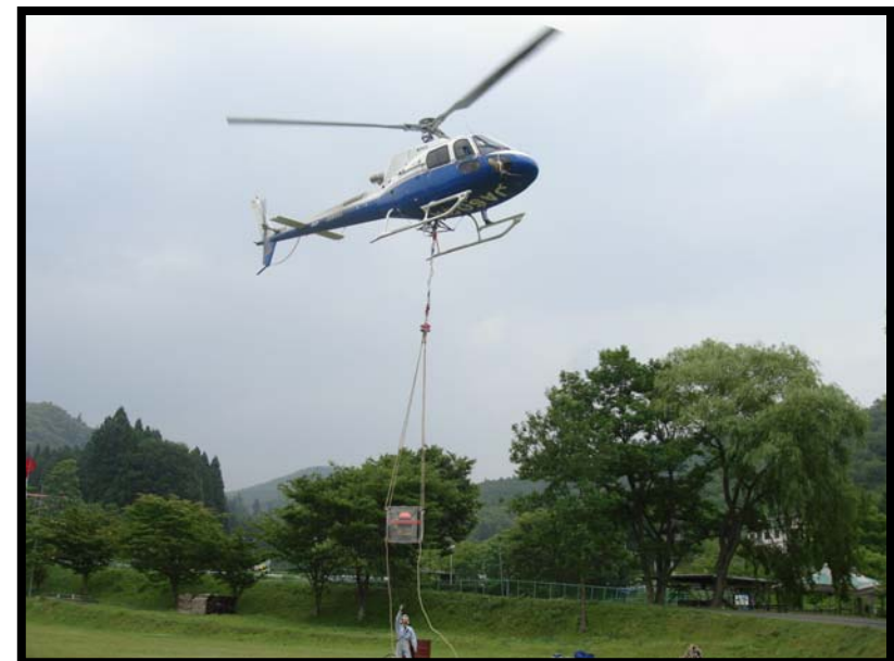
土研式水位計運搬状況
