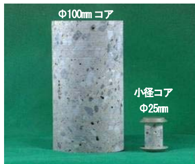
(写真右) 小径コアφ25mmのサイズ
