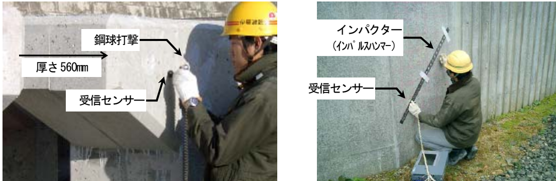
(写真) 衝撃弾性波測定状況
