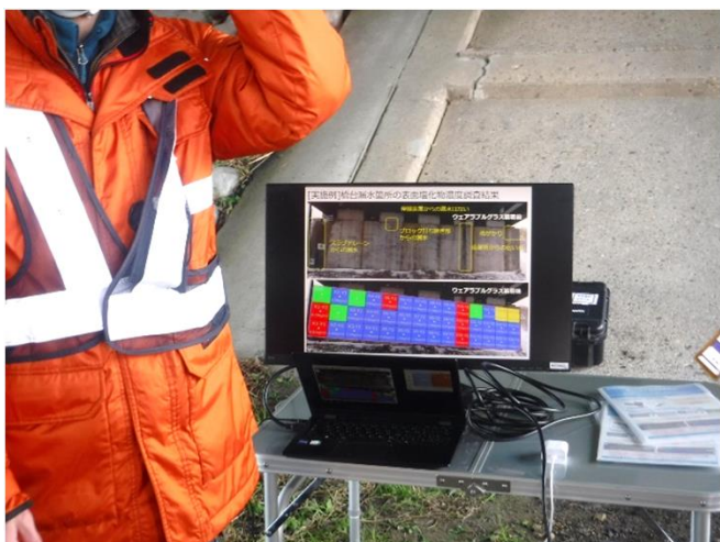
▲非破壊検査と拡張現実技術を組み合わせた新しい塩分濃度調査技術
