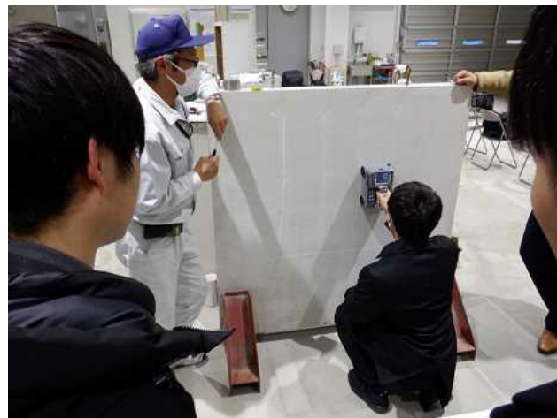
非破壊検査(鉄筋探査)体験
