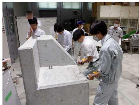
非破壊検査(テストハンマー)体験
