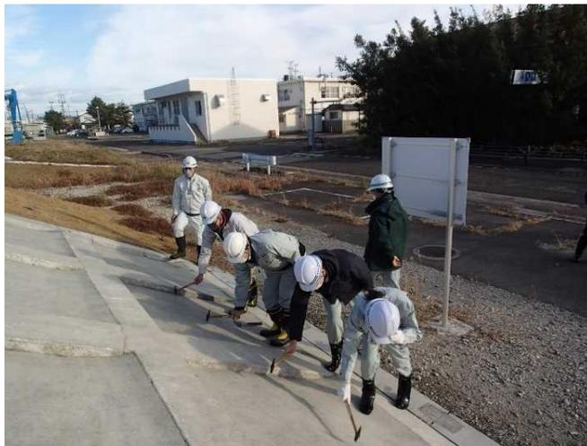
打音による護岸の空洞化調査の体験
