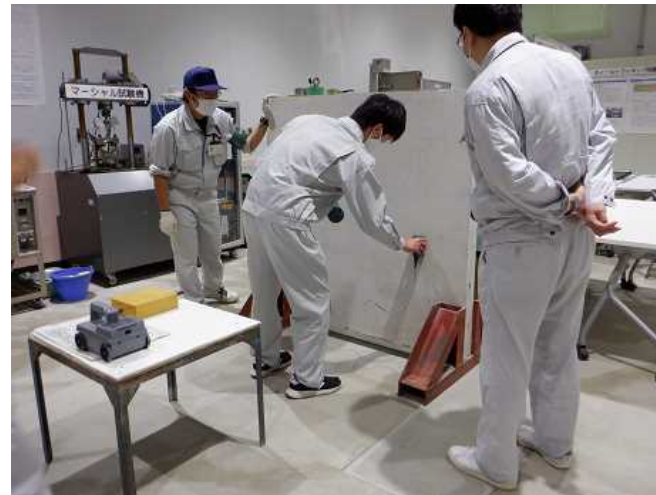
非破壊検査(鉄筋探査)体験
