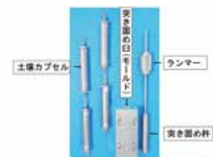
土壌浄化モニタリングカプセル及び突きぬめ針調整機
