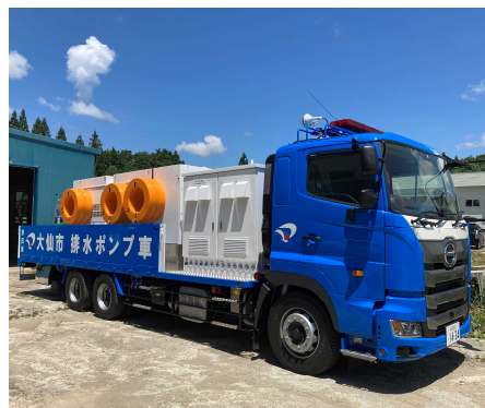
排水ポンプ車の導入
