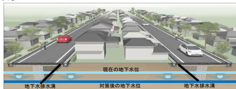
道路と宅地との一体的な液状化対策を行う工法のイメージ（地下水位低下工法）
