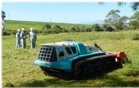
大型遠隔式草刈機操縦の様子
