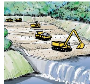
貯砂ダム(貯めて取る)
