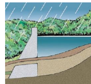
堆砂ゲート(土砂フラッシュ)
