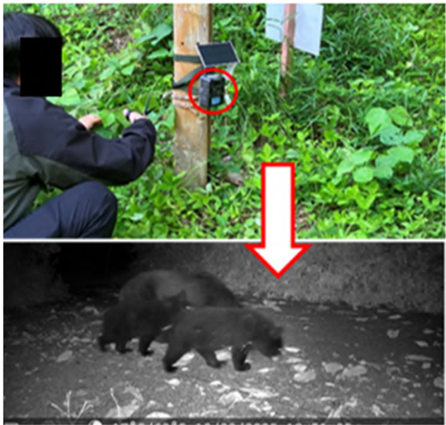
▲管理施設内の監視カメラ設置（事例は、動物などの動きに反応して録画するタイプの監視カメラを設置）
