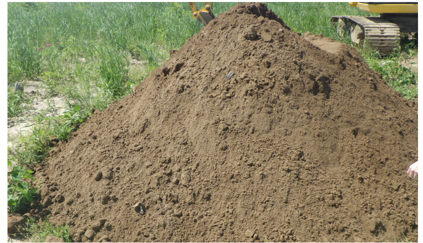
▲ 当初土質状況確認時写真 (砂質系土砂)
