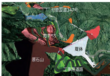
ダム設計段階から 3次元データを活用
