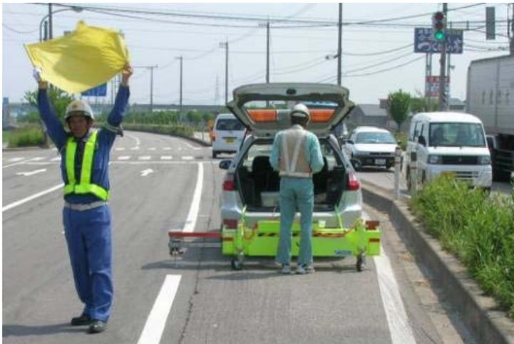
レーザープロファイラでの測定
