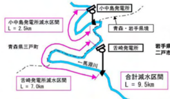
図 取水調整による改善区間
