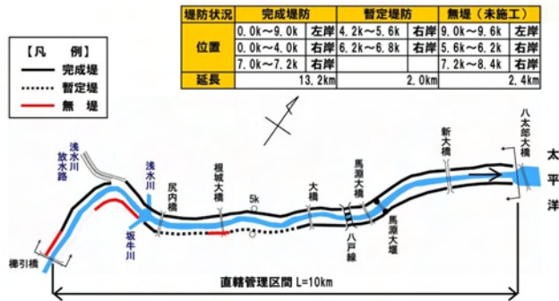
図 3.7 堤防整備状況
