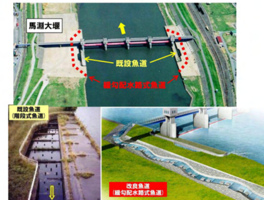
図 5.13 馬淵大堰の魚道の改良イメージ
