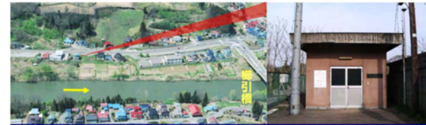
【橋引橋水質自動観測所】 毎時間の水温、ph、DO、導電率、濁度を計測し、リアルタイムで公表
