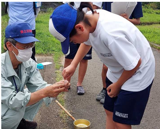
パックテストによる簡易水質調査
