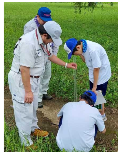
透視度計による透明度測定
