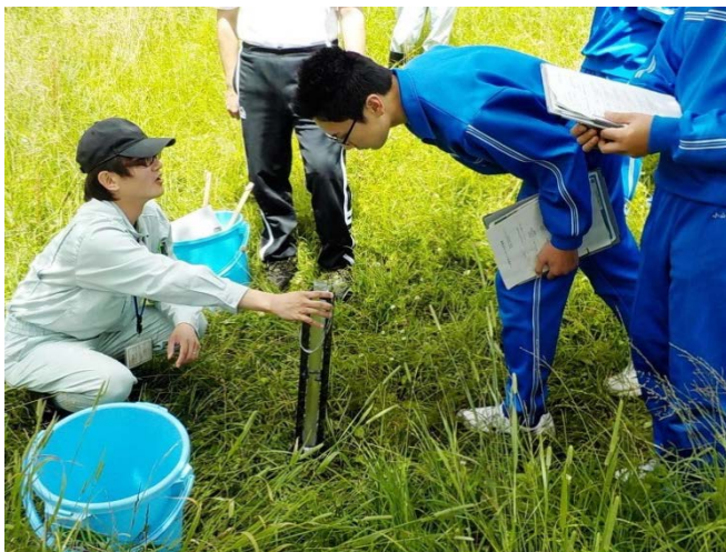
▲透視度計を使った水の透明度の測定▲
