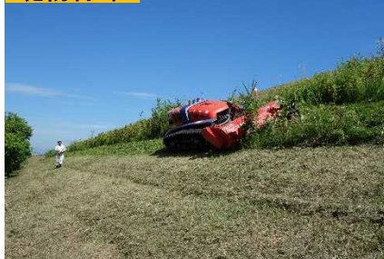
大型遠隔除草機械による除草
