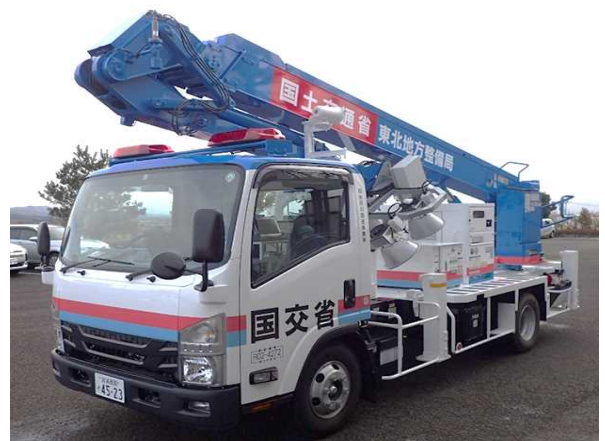
照明装置:2kW × 6灯 ※最大高さ20mからの照射が可能
