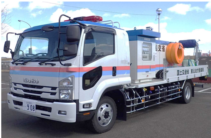
排水能力:30m 3 /min ※小学校 25mプールを約10分で空にすることが可能
